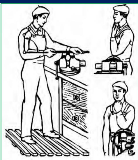
شکل ۱۶-۱- روش صحیح ایستادن و ارتفاع مناسب گیره
